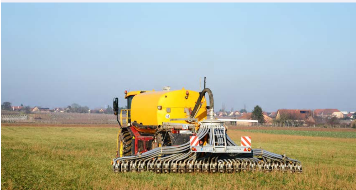
Photo 6.3 : Avec le procédé de rampes à pendillards (tuyaux souples), le produit méthanisé liquide est déposé dans la couche supérieure du sol. La volatilisation de l'ammoniac est ainsi fortement réduite.
