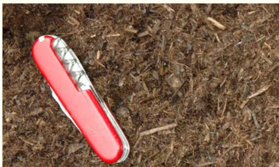
Photo 2.1: Les produits méthanisés solides (ici fumier méthanisé) présentent toujours une structure très fibreuse, car la lignine n'est pas dégradée en conditions anaérobies.
